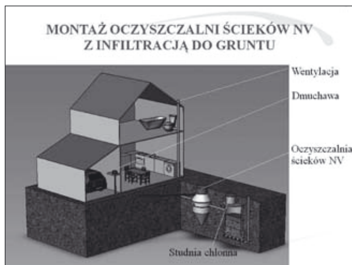
Przydomowa oczyszczalnia ścieków.
